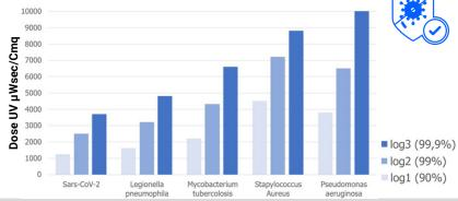
Riduzione microbica fino a log3 su flusso d'aria, coil e superfici HVAC, 24 ore al giorno.
