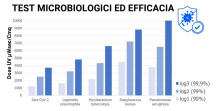
Riduzione microbica fino a log3 su flusso d'aria, coil e superfici HVAC, 24 ore al giorno.
